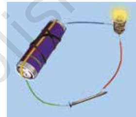
चित्र 20.2 परीक्षण करना कि क्या विद्युत टेस्टर के लोहे की कील के सम्पर्क में आने पर बल्ब दीप्त होता है
