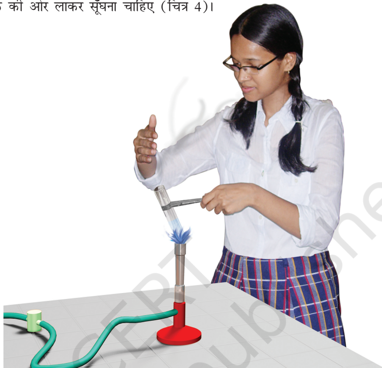
चित्र 4 : वाष्पों की गंध को जानने तथा क्वथन नली को गर्म करने की सही विधि
